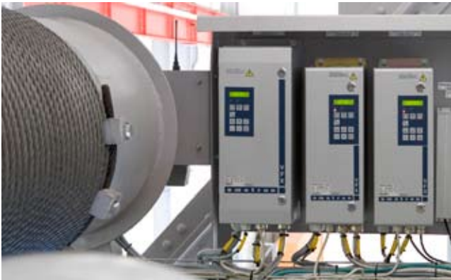
Door de IP54-behuizing kunnen de frequentieregelaars op de kraanbruggen en de lier worden geïnstalleerd. Dit bespaart installatiekosten.
