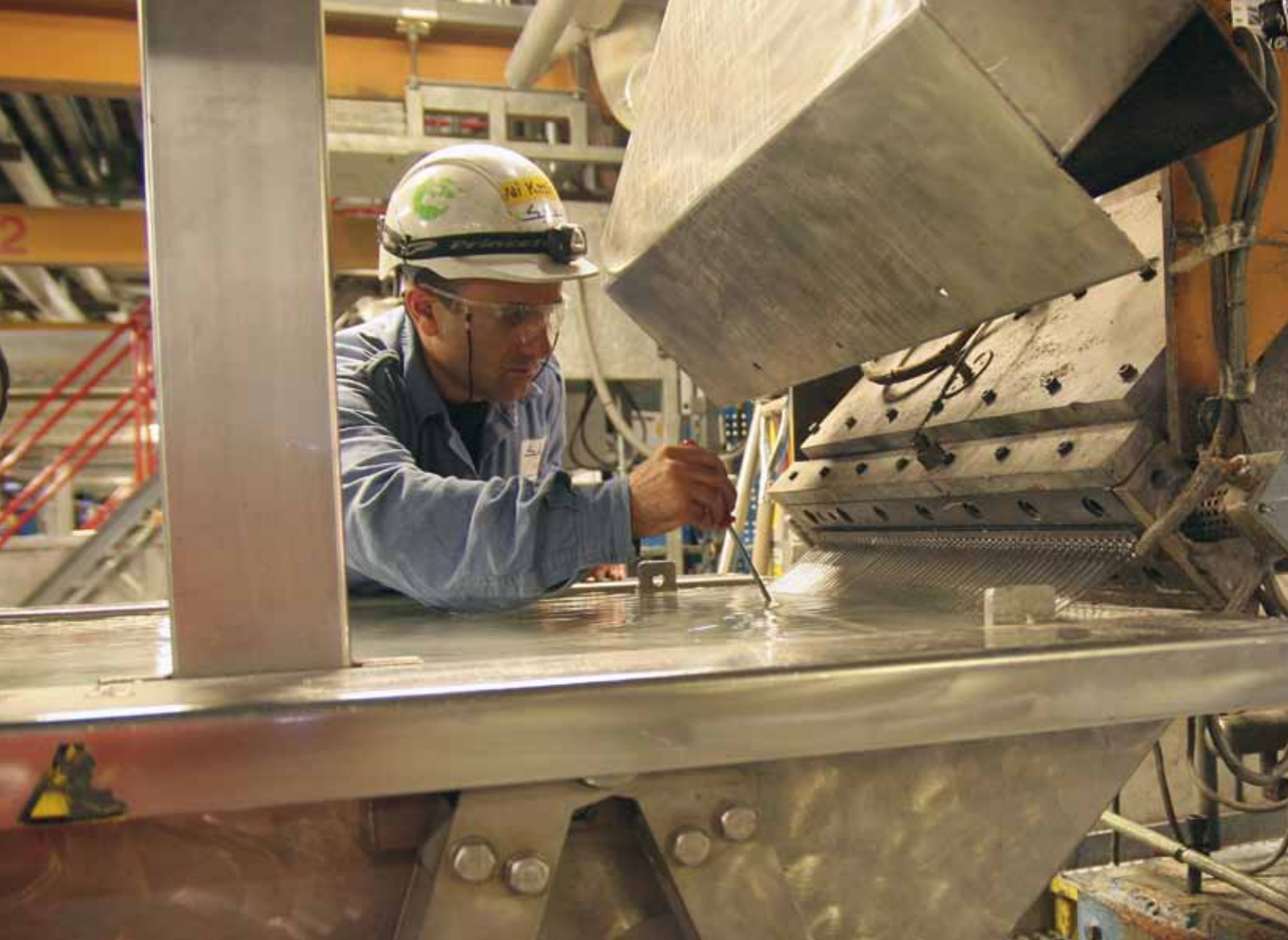
Alle door elektromotoren aangedreven toepassingen binnen het productieproces worden geregeld door Emotron-frequentieregelaars. Bijna 250 eenheden regelen alles, van 370 W-pompen tot 800 kW-extruders.
