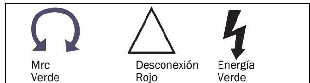
Fig. 98 Indicaciones de los LED.
